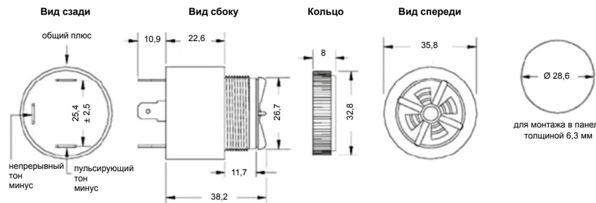
для монтажа в панель толщиной 6,3 мм
