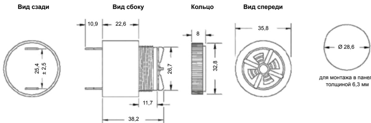
для монтажа в панель толщиной 6,3 мм
