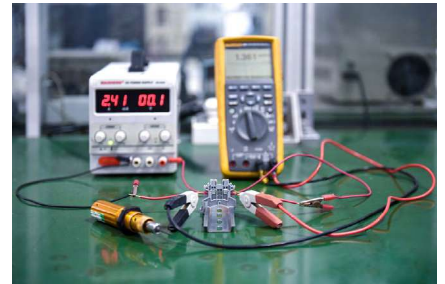
Испытание винтовых клемм на падение напряжения
