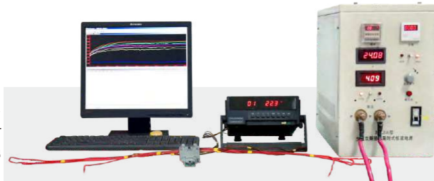
Испытание на нагрев клемм под нагрузкой
