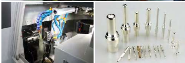
Станок по производству контактов кручением
