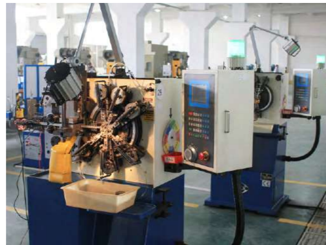
Автоматический станок по производству пружин
