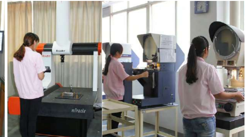
1 трехмерный измерительный прибор Высокоточный проектор 12 комплектов
