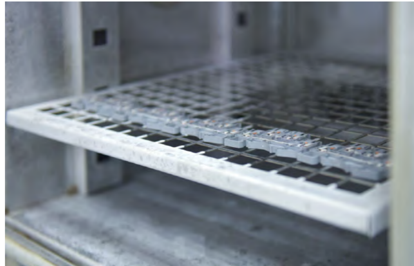
Циклические температурные испытания клемм на DIN-рейку
