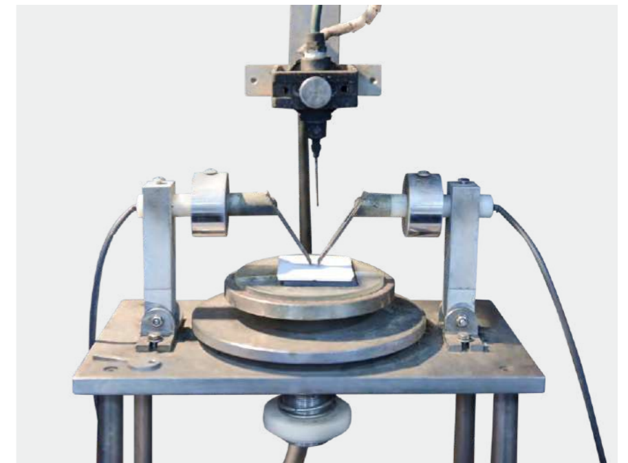
Испытание на CTI клемм на DIN-рейку
