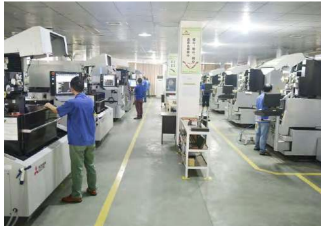
11 станков медленной резки провода
