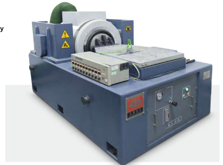
Испытательная установка для вибрационных нагрузок
