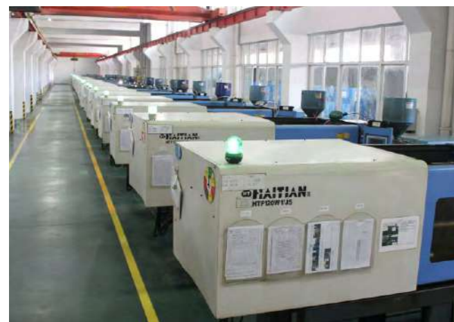
Прецизионный термопласт автомат
