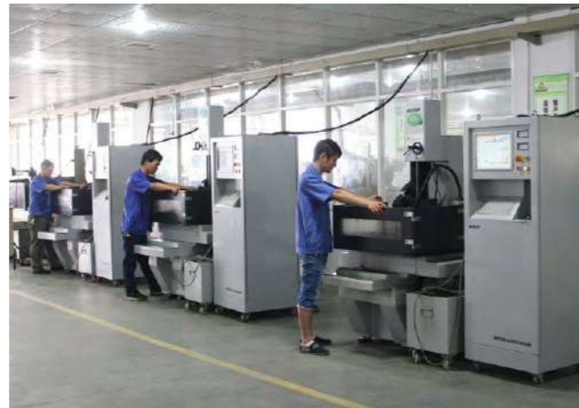
11 станков среднескоростной резки провода
