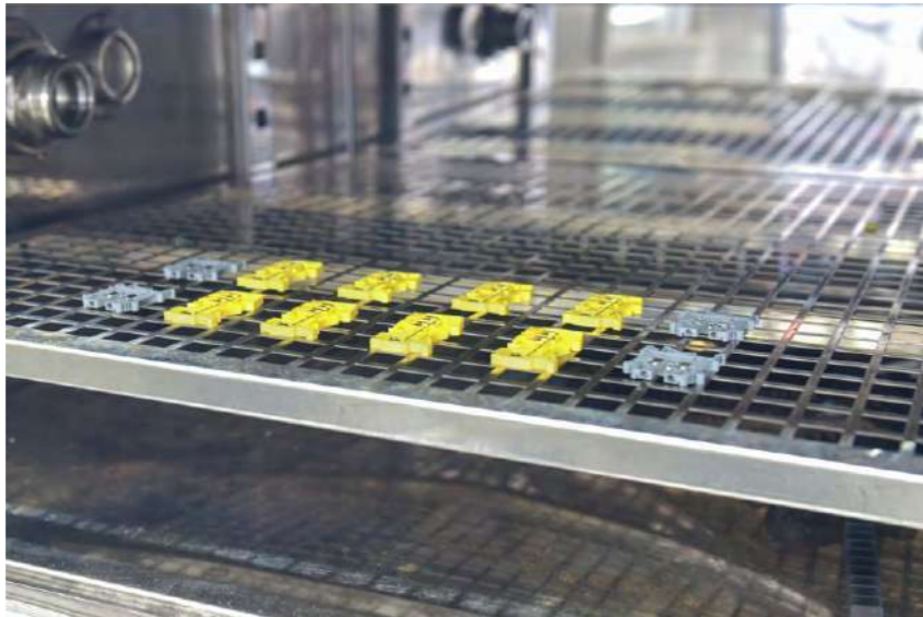
Циклические температурные испытания клемм на DIN-рейку
