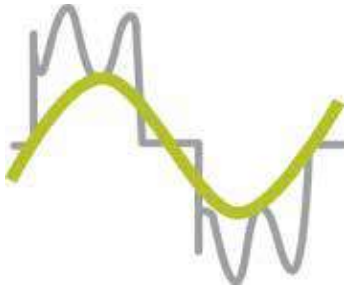
Altivar Process: искажение кривой тока, потребляемого из сети
