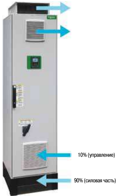
Система охлаждения с разделением потоков воздуха
